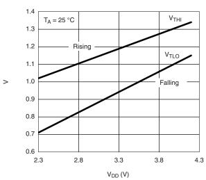
IN Threshold Voltage vs.  $V_{\rm DD}$
