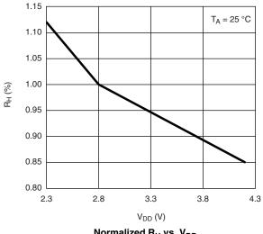
Normalized  $R_{\rm H}$  vs.  $V_{\rm DD}$
